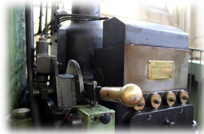
Der VMA266 ist ein Deutz Dieselmotor – und der einzige, erhaltene seiner Bauart weltweit. Bei einer Drehzahl von 250 Umdrehungen in der Minute leistet er 1000 PS. Damit konnten im AEG Stromgenerator ca. 750.000 Watt elektrische Energie erzeugt werden. Seit vielen Jahren begeistert dieser Motor die Besucher – und er läuft wie am ersten Tag.
